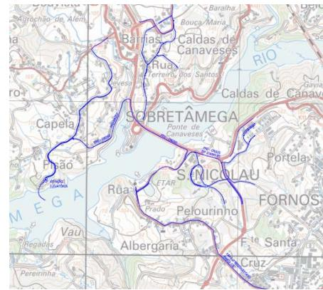
Uma intervenção particular contemplada neste projeto é a instalação de condutas sob pressão (de água para abastecimento e de água residual) ao longo da Ponte de Canaveses, para atravessamento do rio Tâmega.
